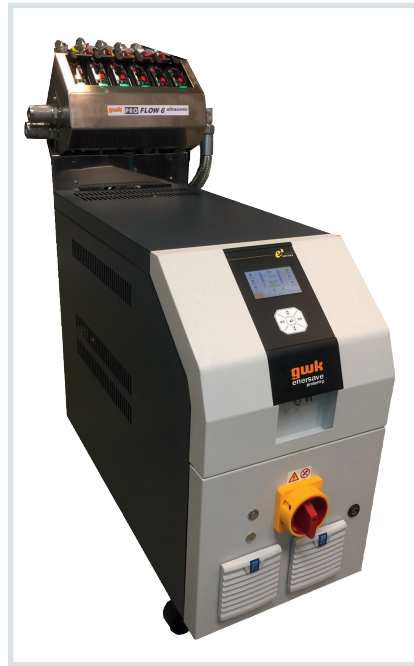
Bild 3. Je größer die Pumpenleistung, desto größer der energetische Vorteil zugunsten der Zentrifugalpumpe. Hier ein Modell aus der Serie enersave mit Wasserverteiler mit berührungsloser Ultraschall-Durchflussmessung (© gwk)
